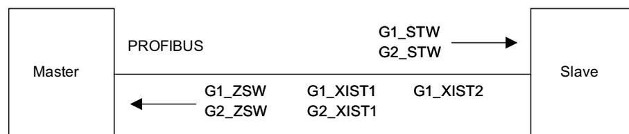
Figure 4-2 Example of encoder interface (encoder 1: Two actual values, encoder 2: One actual value)
